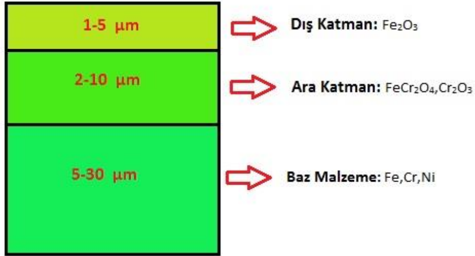
Şekil 2: Kontaminasyonun malzeme yüzeyinde yer aldığı katmanlar ve derinlikleri
