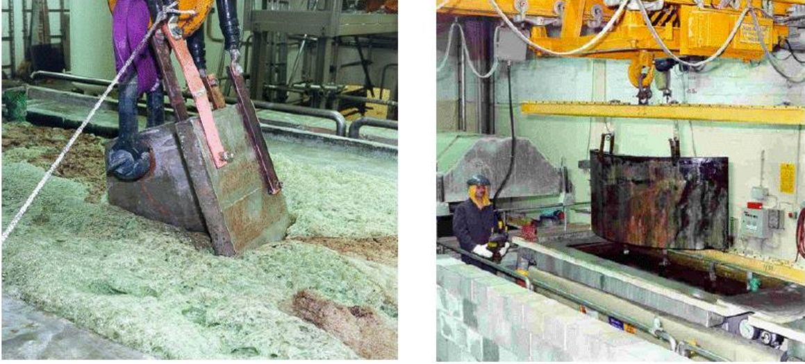
Şekil 6: Fosforik asit banyosunda elektrokimyasal dekontaminasyon işlemi
