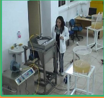
Atık su ışınlama ünitesi
