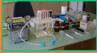
Östrojenlerin sulardan katıfaz yöntemi ile ekstraksiyonu
