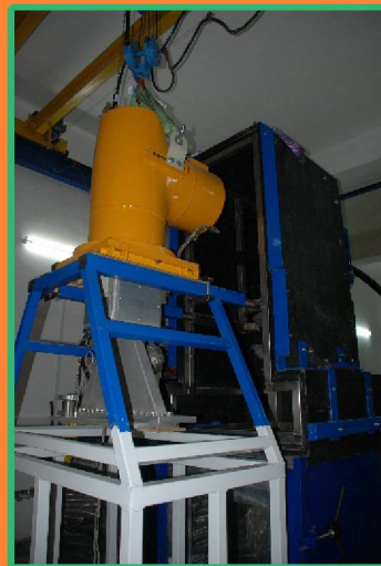
Kendinden zırhlı elektron hızlandırıcısının, hızlandırıcı ve tarayıcı bölümünün bakım amaçlı olarak zırhından çıkartılmış görünümü.
