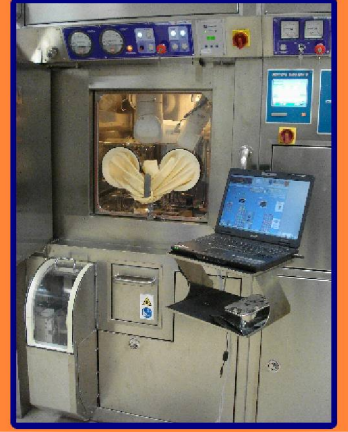
Dağıtım sıcak hücresi
