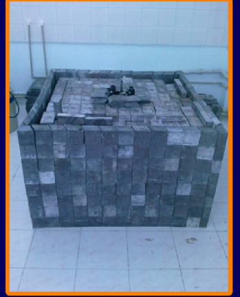
3 x 592 GBq 241 Am-Be nötron ışınlama hücresi
