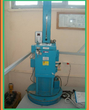
10.000 Ci üretim aktiviteli MARK- I 22 M Cs -137 deneysel gama ışınlama cihazı
