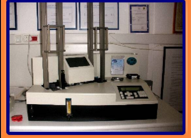
Tek dedektörlü otomatik alfa/beta sayım sistemi
