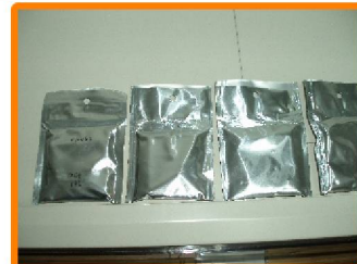
Açık ortamda TLD ile çevre dozu ölçümü
