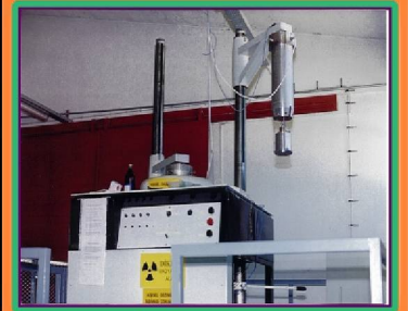
10.000 Ci üretim aktiviteli PX-30 ISSLEDOVATELJ Co -60 deneysel gama ışınlama cihazı
