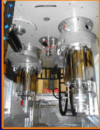
Proton hızlandırıcısı vakum pompaları
