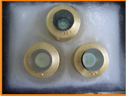
Fırınlama öncesi dozimetrik kristallerin hazırlanışı
