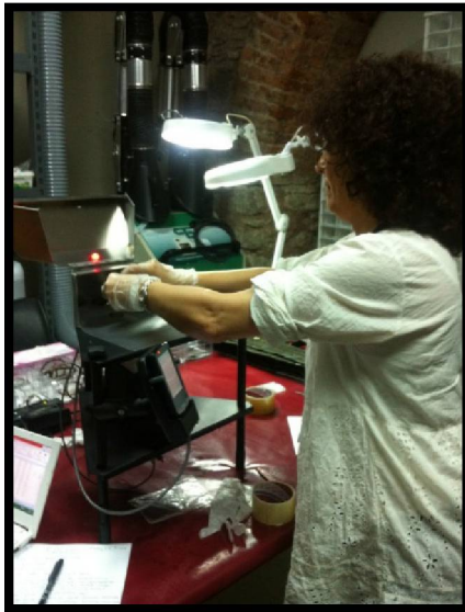
Şekil 4. Urartu Eserlerinin Portatif EDXRF ile İncelenmesi
