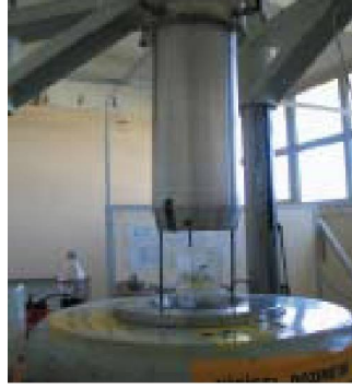
Şekil 2.1.2. In vitro bitkilerin Co 60 ışın kaynağı ile ışınlanması
