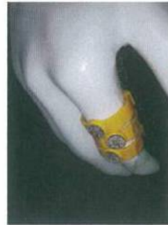
Resim 6. TI. ve Yüzük Dozimetreleri
