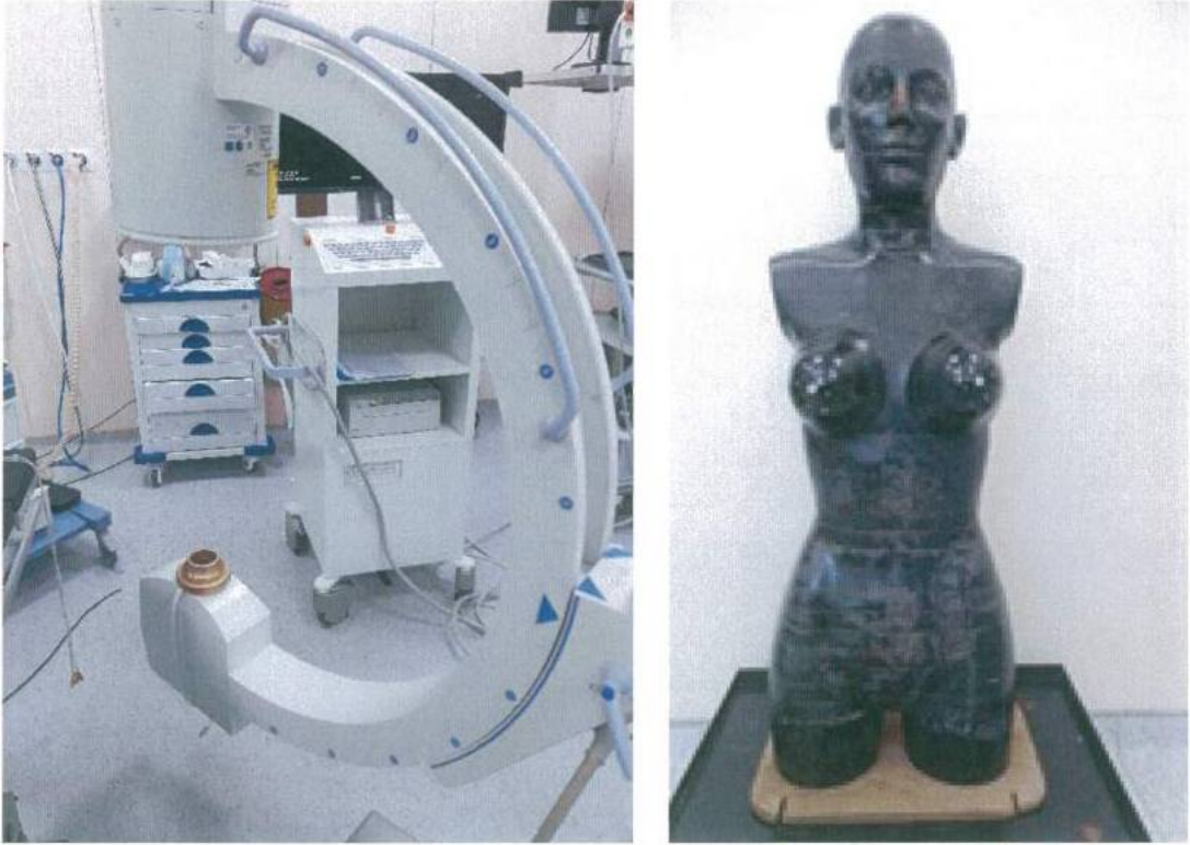
Resim 2. C-kollu skopi cihazı ve rando fantom
