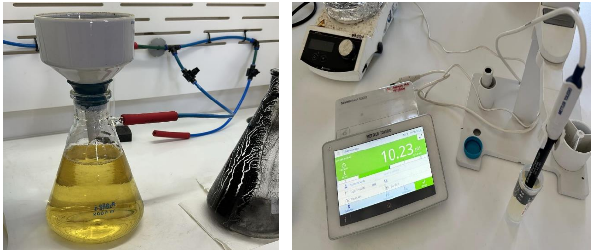
Şekil 6. Endüstriyel NiMH siyah kütesinin yıkama sıvısı ve pH değeri
