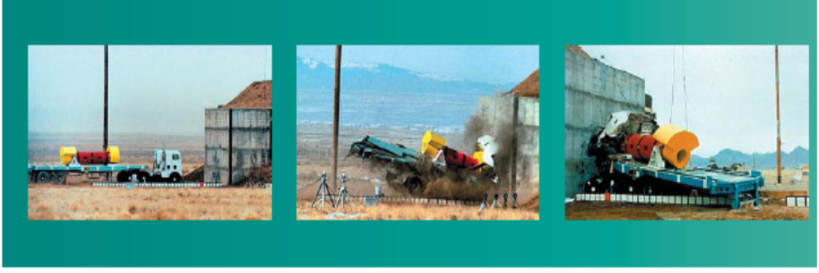
Nükleer Yakıt Taşıma Kabının Test Edilmesi
