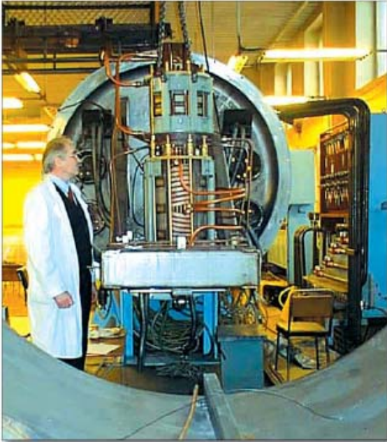
Reaktör kazanı fenomenlerini araştıran MASCA deneysel programı için hazırlanmakta olan RASPLAV düzeneği
