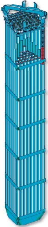
BWR Yakıt Demeti (Yaklaşık 4 m uzunluğunda ve 300 kg ağırlığında)
