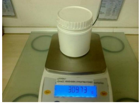
Şekil 13. Yeterlilik testi numunesinin ağırlığının belirlenmesi işlemi (20 mg hassasiyete sahip terazi)
