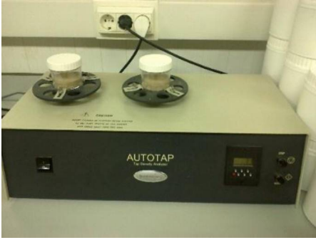
Şekil 12. Yeterlilik testi numunelerinin numune kabında sıkıştırılarak içerisindeki hava boşluklarının alınması işlemi. (Quantachrome dual auto tap cihazı kullanılmıştır)
