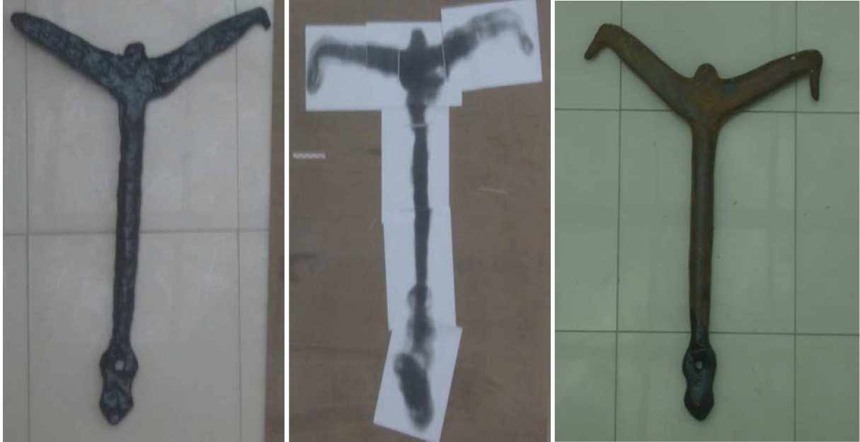
Şekil 9. CNC çıktı üzerinde radyografik inceleme yardımı ile yapılan tamamlamalar.
